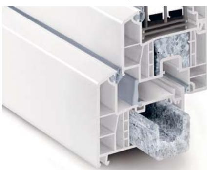
□ **Passivhausfenster** | Durch optionale Thermo module in den integrierten Funktionskammern erreicht das 6-Kammer-System passivhaustaugliche Bemessungswerte von bis zu  $U_{f,BW} = 0,8$  W/m<sup>2</sup>K.
