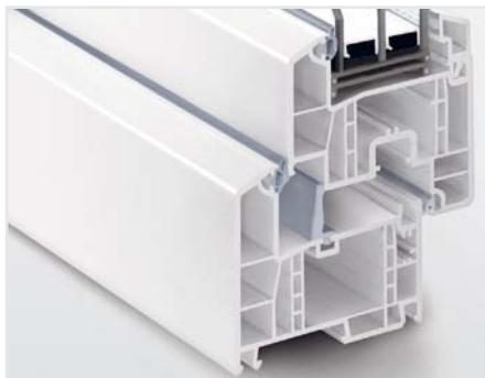
■ **86 mm Bautiefe** | Bereits ohne zusätzliche Dämmmaßnahmen wird ein  $U_f$ -Wert = 1,0 W/m<sup>2</sup>K erreicht. HBI-Kunststofffenster mit GFK-Profilkern\* eignen sich deshalb ideal für Niedrigenergiehäuser und die energiebewusste Altbauanierung.
