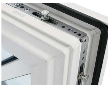
□ **Sicherheitsbeschlag WK 2** | Hinteregreifende Schließzapfen und entsprechend abgestimmte Schließstücke aus Stahl verhindern zuverlässig ein Aufheben des Fensters.
