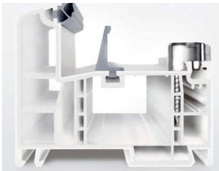
■ **Optimierte Profilgeometrie** | Verstärkte Schraubkanäle im GFK-Profilkern\* mit zusätzlichen Queraussteifungen sorgen an den entscheidenden Stellen für hervorragende Befestigungseigenschaften und effektive Einbruchhemmung.
